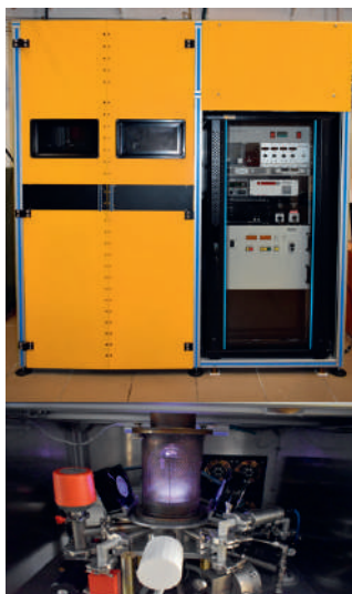
2. ábra: Az általunk épített és a Wigner Fizikai Kutatóközpontban üzemelő MWCVD gyémántleválasztó berendezés (felső ábra) és gyémántnövesztés során a mintatérben a forrásgázok mikrohullámú aktiválásával létrejövő plazmagömb (alsó ábra).
