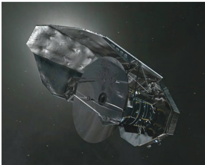
2. ábra: A Herschel, az ESA legkorszerűbb űrbéli kutatóállomása, egyben a legnagyobb valaha pályára állított infravörös teleszkóp, amely 2009 és 2013 között végezte küldetését. Forrás: AOES Medialab (2008) [10].
